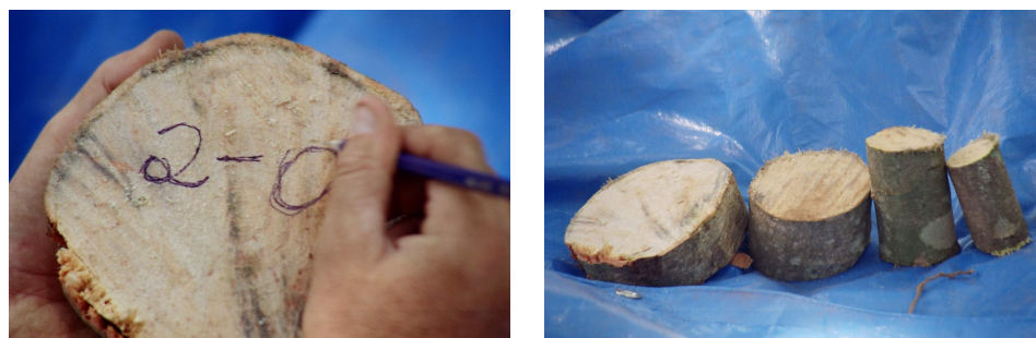
Figura 6: Identificação de cada amostra retirada do fuste, indicando árvore e posição da amostra nas árvores, e o acondicionamento final das amostras para determinação do teor de umidade.
