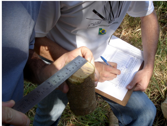
Figura 1: Medição do diâmetro de uma amostra do fuste para determinação posterior do teor de casca e da biomassa.
