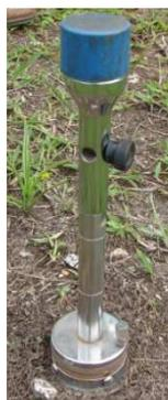
Figura 14 - Exemplo de trado para coleta de amostra indeformada de solo.
