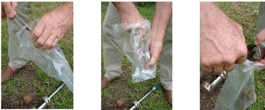
Figura 18 – Procedimentos finais para amostra indeformada de solos – 0 a 20cm
