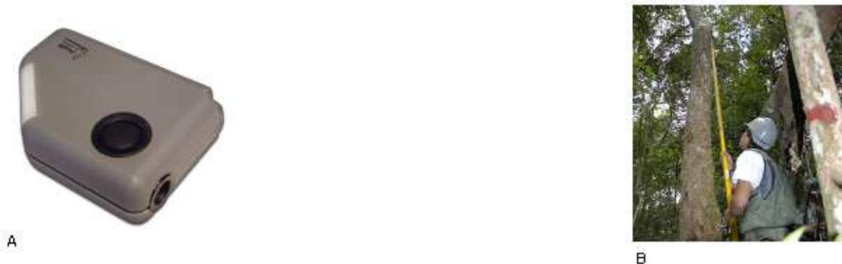
Figura 32: Aparelhos para medição de alturas: A – clinômetro, e B - régua graduada
