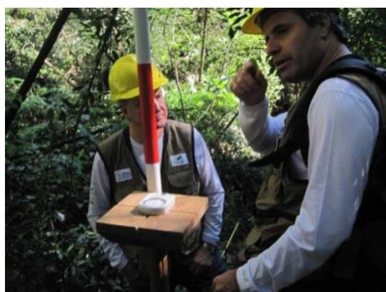
Figura 6 - Bússola apoiada sobre a cruzeta instalada no ponto central do conglomerado.
