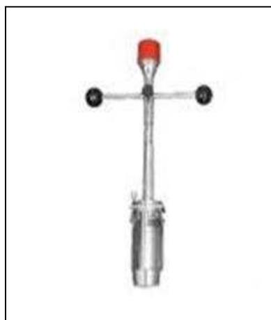
Figura 11 – Trado para coleta de amostras indeformadas de solo.
