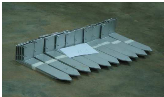
Figura 7 – Marco padrão de alumínio a ser enterrado no ponto central do conglomerado e no início de cada subunidade
