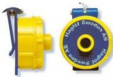
Como a medida da distância é baseada no ultrassom, qualquer fator ou situação que altere a velocidade do ultrassom deve ser considerado, ou seja, temperatura e umidade. Assim, o instrumento deve ser calibrado diariamente ou, no caso de mudanças climáticas durante o dia, mais de uma vez por dia. Em momentos de chuva intensa e alta umidade do ar o DME se torna praticamente inútil.
