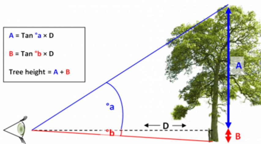
O clinômetro fornecerá as tangentes dos ângulos de visada do topo (Tan a) e da base (Tan b). Com o conhecimento da distância do observador (D) à árvore, é possível se determinar a altura da árvore
