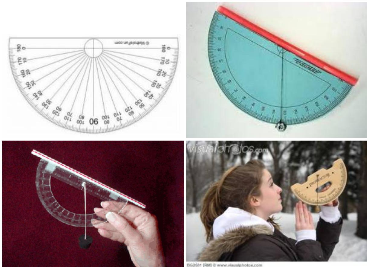
Para medir a altura das árvores, será necessário dispor de uma *tabela de tangentes* ou de uma calculadora científica para converter os ângulos em tangentes.
